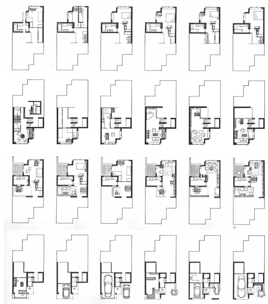
Abb. 7 Delft (Niederlande), Diagoon Houses, 1967–71, Arch. Herman Hertzberger, verschiedene Nutzungsszenarien für die Grundrisse vom Erd- bis zum Dachgeschoss.
