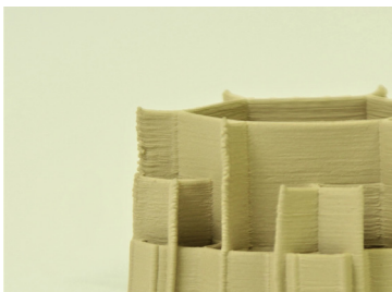
Abb. 10 Detail 3D Keramikstruktur zu Wabenförmigem Stützelement von T. Wilkes und M. Palmén.
