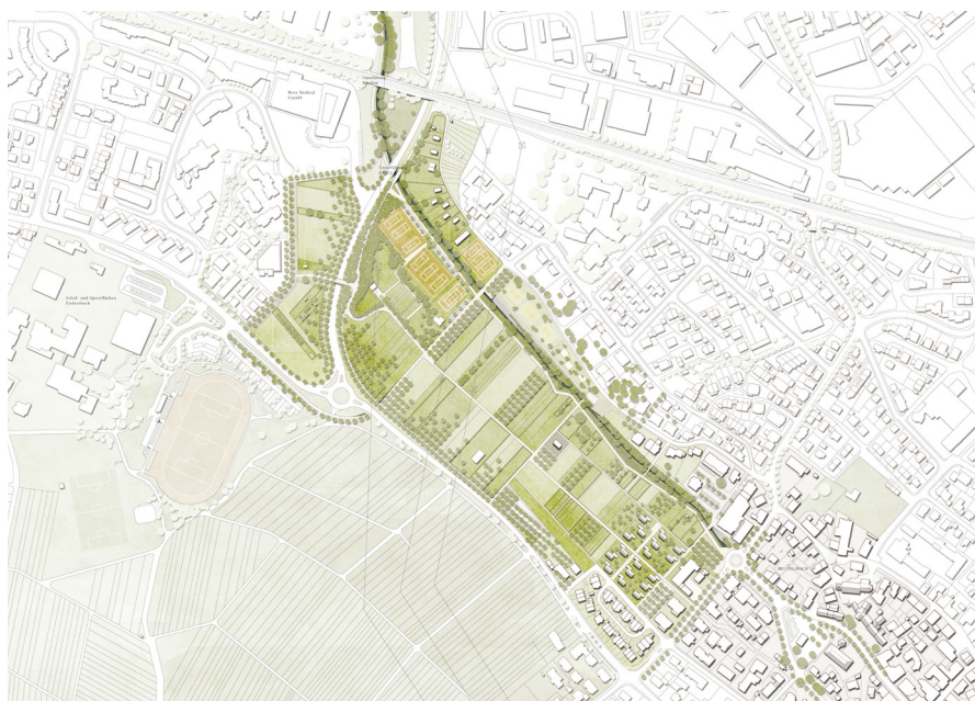
Abb. 4 Der Lageplan illustriert die bewusst erhaltene Parzellierung – die Kernidee des Entwurfs.
